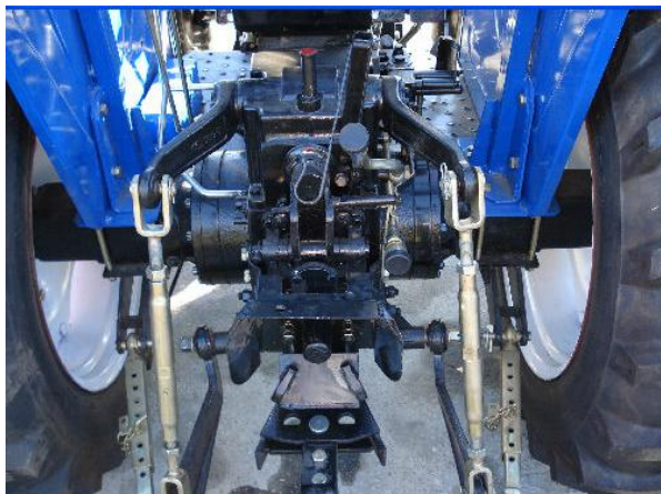
Slika 12. Položaj priključaka na traktor
