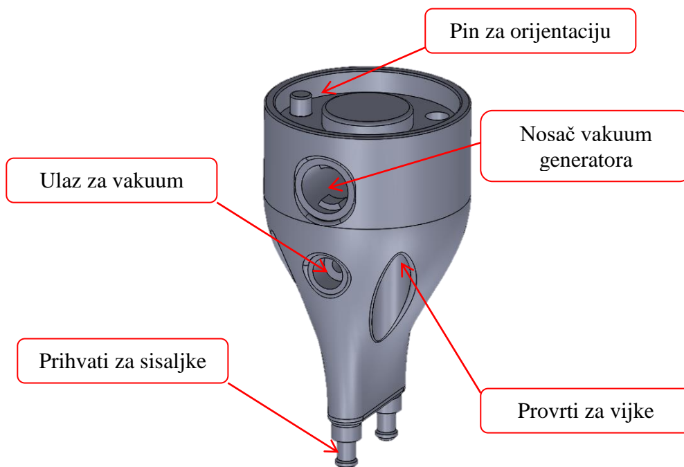
Slika 45. 3D model hvataljke
