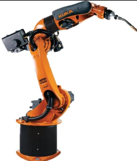
**Slika 6. Robot za zavarivanje**
