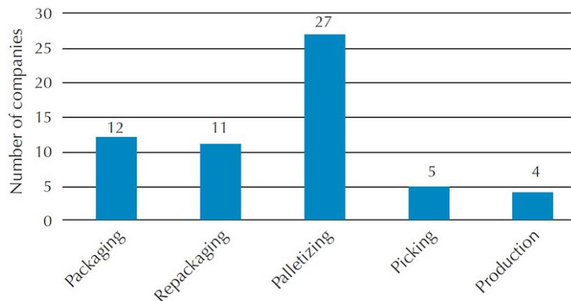
**Slika 7. Udio robota po zadacima u prehrambenoj industriji, Njemačka 2014, [5]**
