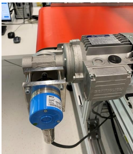
Slika 34. Inkrementalni enkoder na traci
