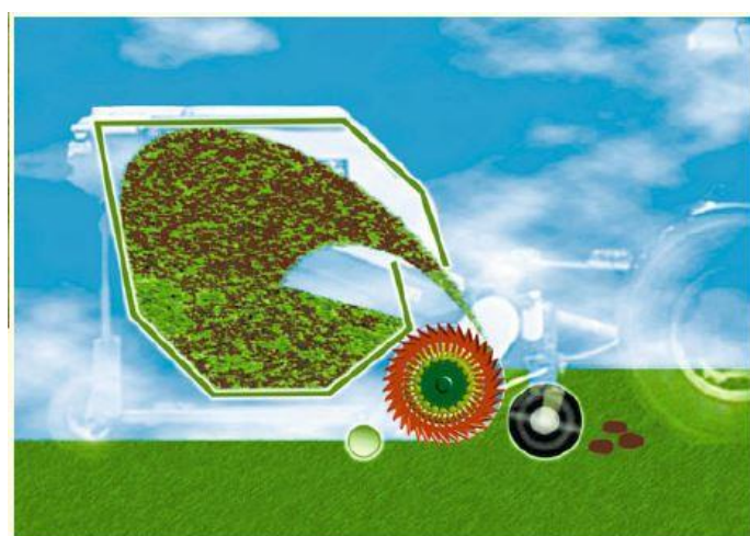
Slika 31. Presjek kosilice pri radu [24]
