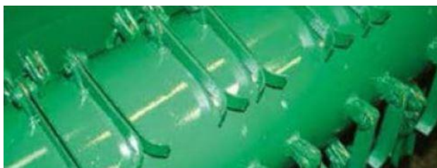
Slika 12. Rezni alati u obliku slova Y [14]
