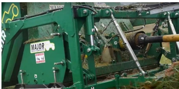
Slika 67. Hidraulički cilindar za regulaciju visine rezanja 37
