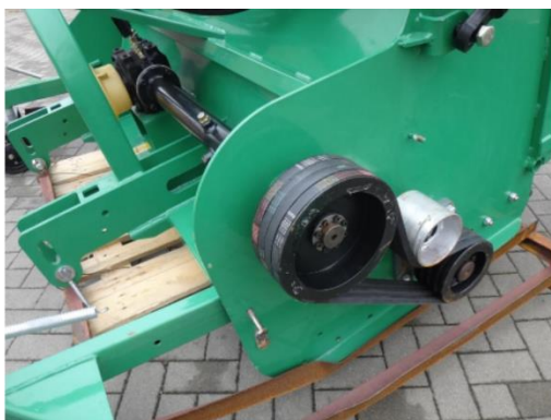
Slika 60. Remenski prijenos na modelu FLP 180 [34]
