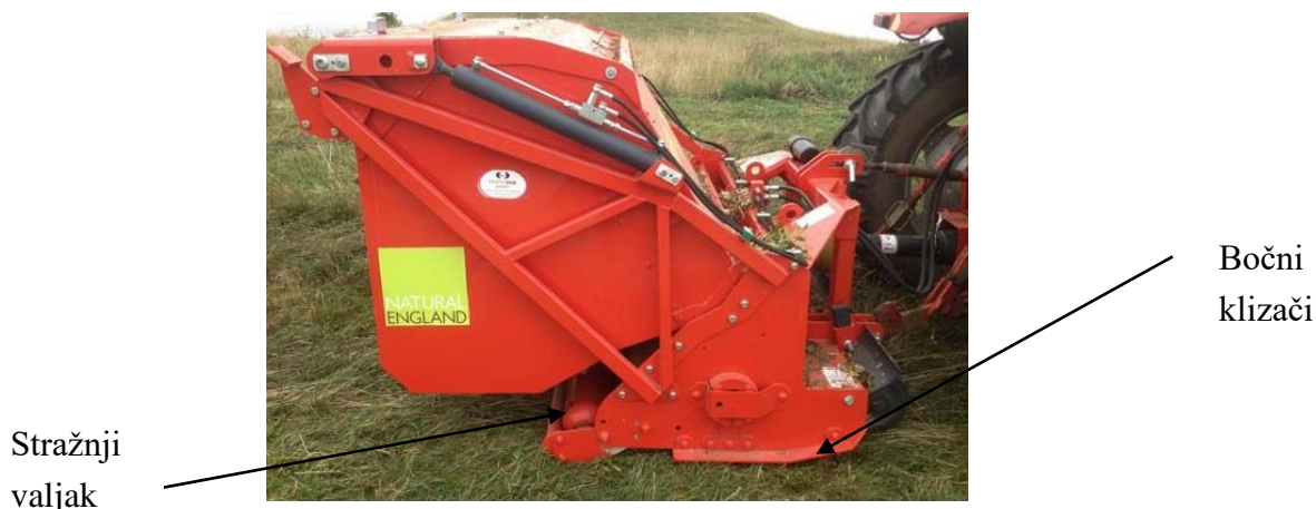
Slika 53. Stražnji valjak i bočni klizač [32]
