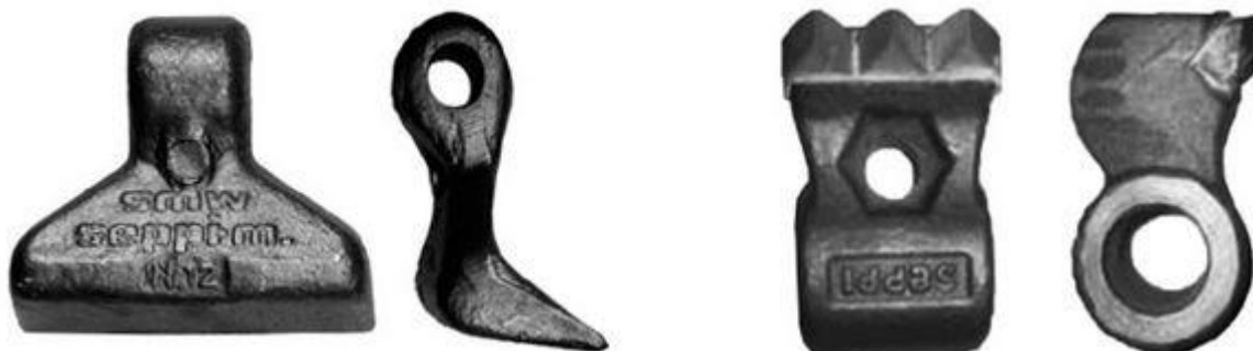
Slika 64. Rezni alati uređaja Midiforst [35]
