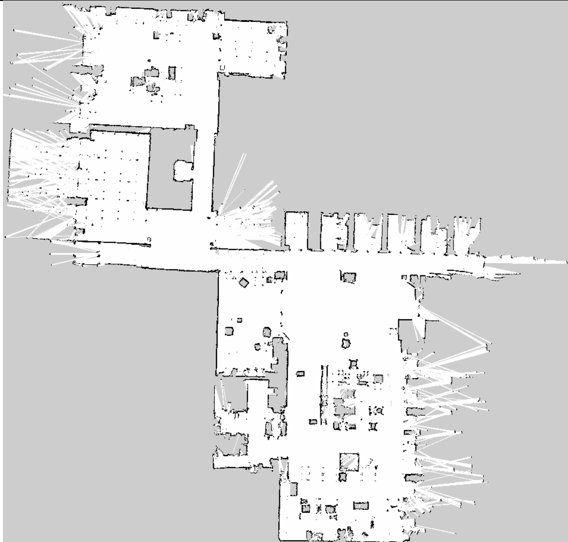
Slika 31. Tlocrt CRTA -e snimljen mobilnim robotom
