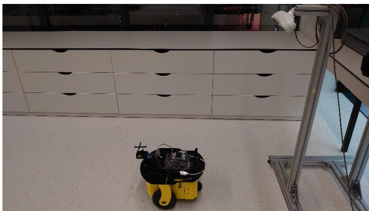
Slika 46. Postav za mjerenje točnosti lokalnih planera
