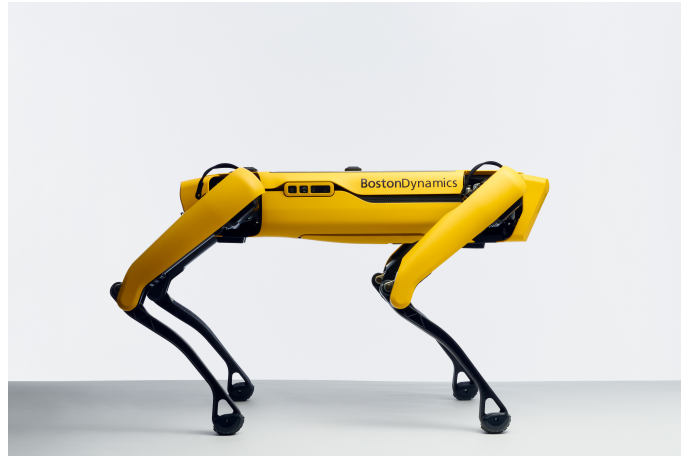
Slika 1.2: Spot, četveronožni komercijalni robot tvrtke Boston Dynamics [4]
