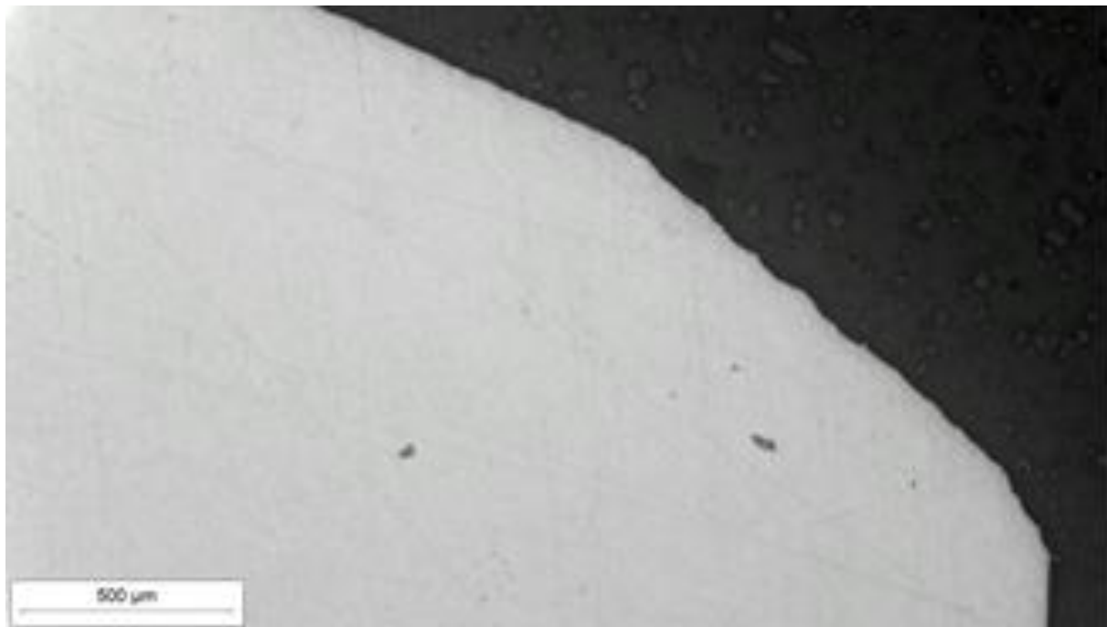
Slika 27. Tribološka oštećenja na površini boka drugog zuba s gornje strane
