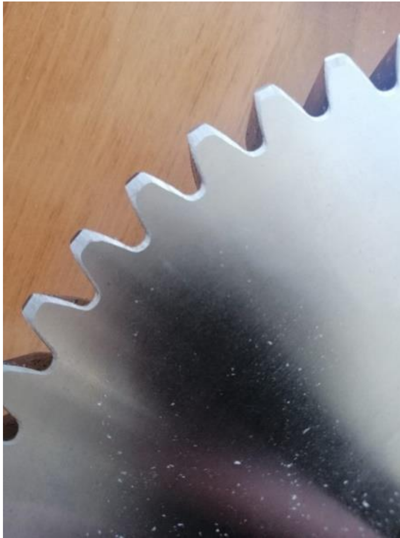
Slika 12. Tribološki oštećeni zubi analiziranog zupčanika
