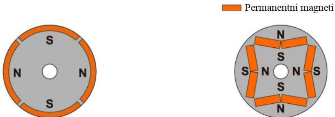
Slika 7. SPM (lijevo) i IPM (desno) [32]
