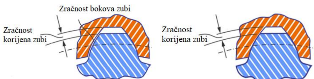
Slika 23. Spojno ozubljenje sa zračnim rasporem (lijevo) i bez njega (desno) [16]
