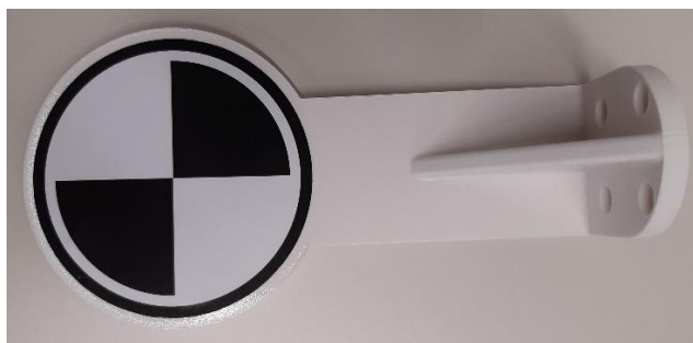
Slika 29. Konačni izgled alata za kalibraciju kamera
