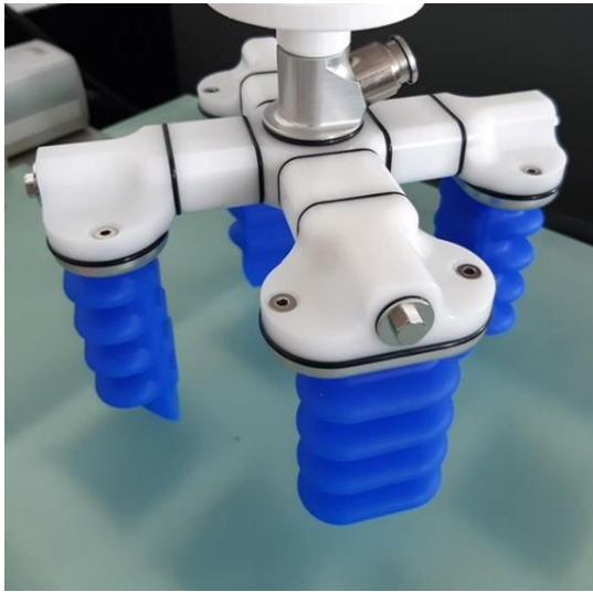
Slika 4. Hvataljka mGrip Soft Robotics
