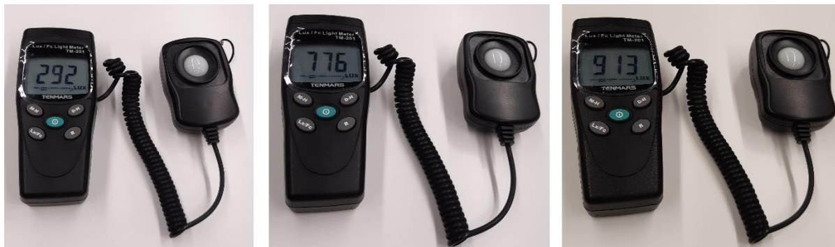
Slika 53. Prikaz izmjerenih vrijednosti intenziteta ambijentalnog osvjetljenja u Laboratoriju za autonomne sustave u CRTA-i
