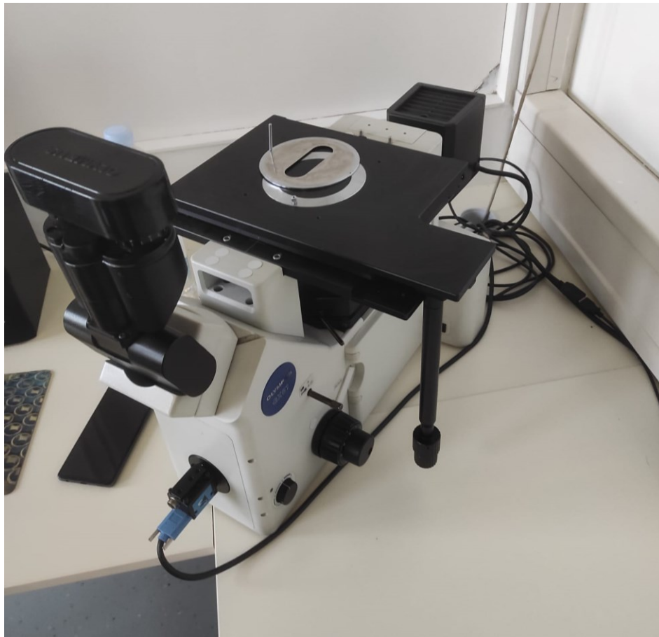
Slika 22. Svjetlosno mikroskop Olympus GX51
