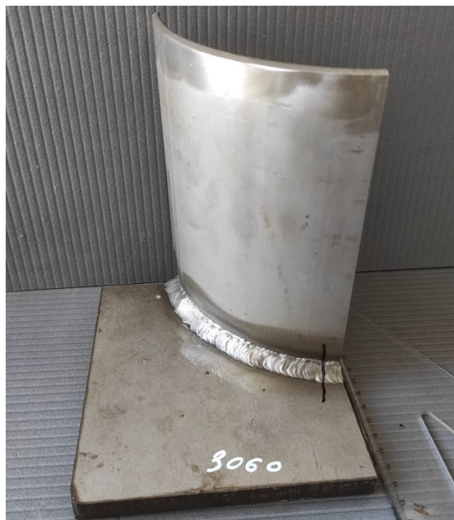
Slika 10. Zavareni spoj ploče i cijevi od austenitnog nehrđajućeg čelika
