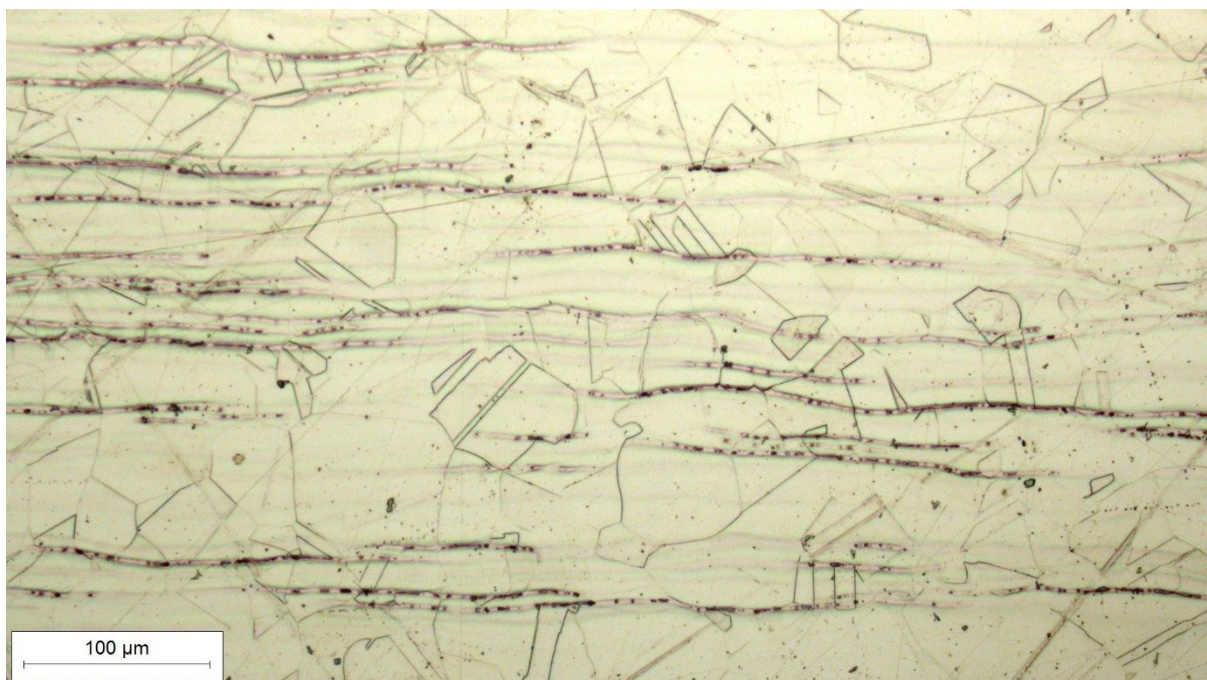
Slika 24. Mikrostruktura srednjeg dijela ploče snimljena pri povećanju 200×
