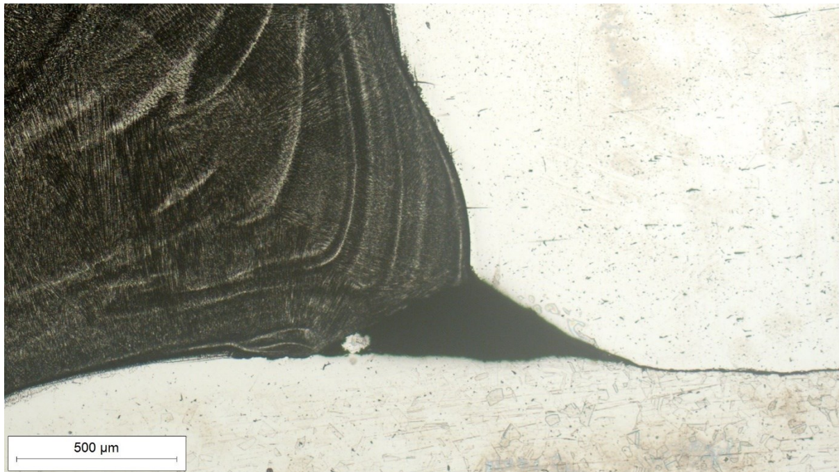
Slika 33. Korijen metala zavara snimljen pri povećanju 50×
