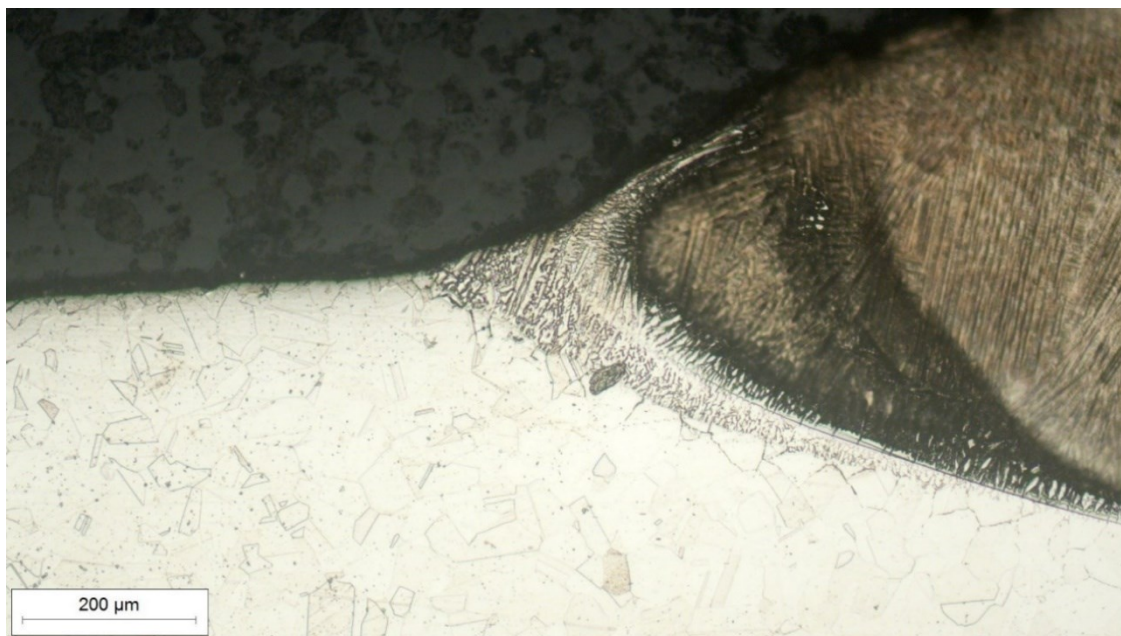
Slika 29. Zona utjecaja topline sa strane ploče snimljena pri povećanju 100×
