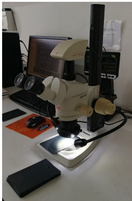
Slika 23. Prikaz stereomikroskopa LEICA MZ6
