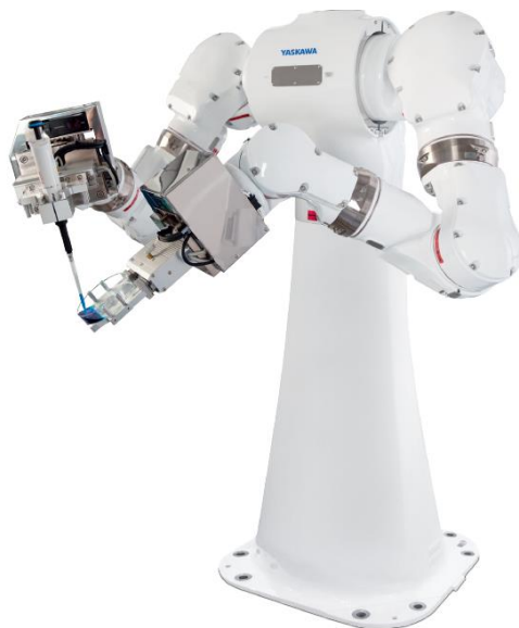
Slika 29. Yaskawa CSDA10F 15-osni manipulator [13]
