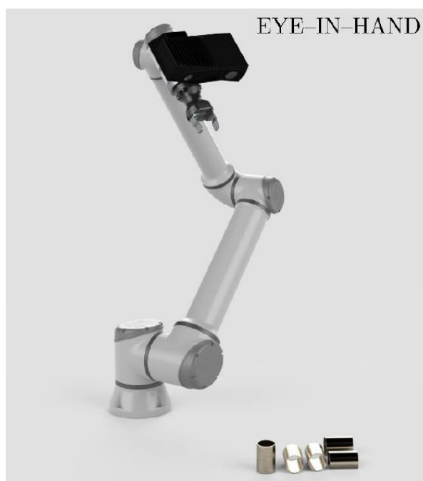
Slika 8. Eye in Hand princip rada [8]
