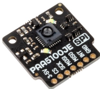
Slika 9. Optički senzor pomaka PAA5100JE[]
