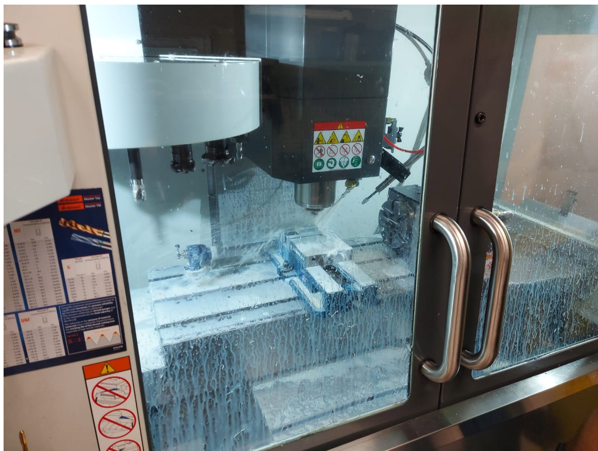
Slika 37. Izrada nosača motora na CNC stroju
