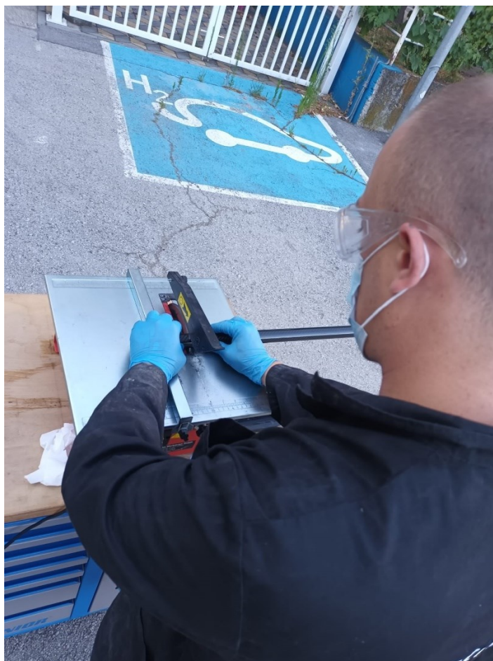
Slika 38. Izrezivanje karbon kompozit cijevi
