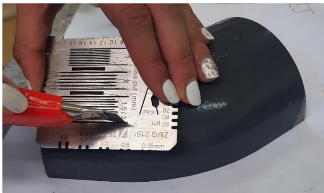
Slika 25. Urezivanje mrežice za ispitivanje prionjivosti
