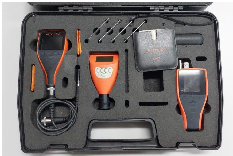
Slika 20. Uređaj za mjerenje debljine prevlake – Elcometer 456
