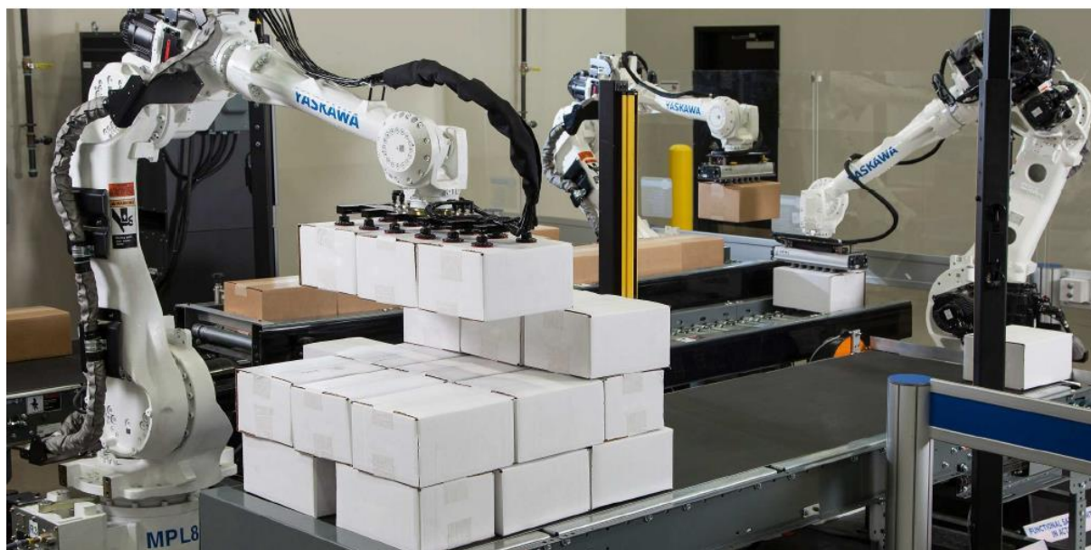
Slika 2. Industrijski robot za paletizaciju sa šest stupnjeva slobode gibanja [2]
