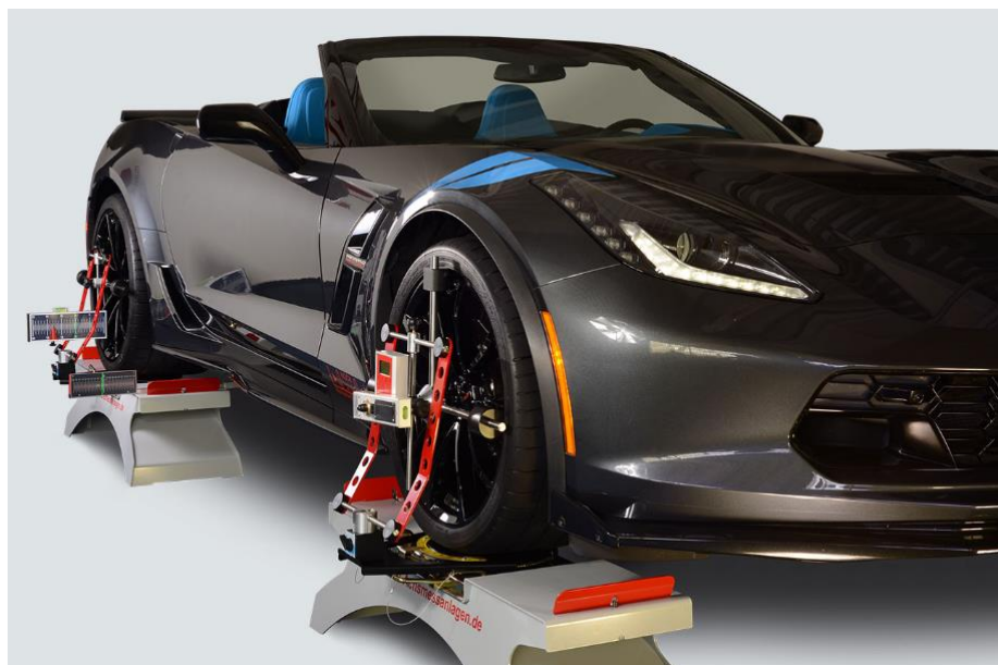
Slika 4.14. Koch-Achsmessanlagen HD-10 EasyTouch Racing Plus [15]
