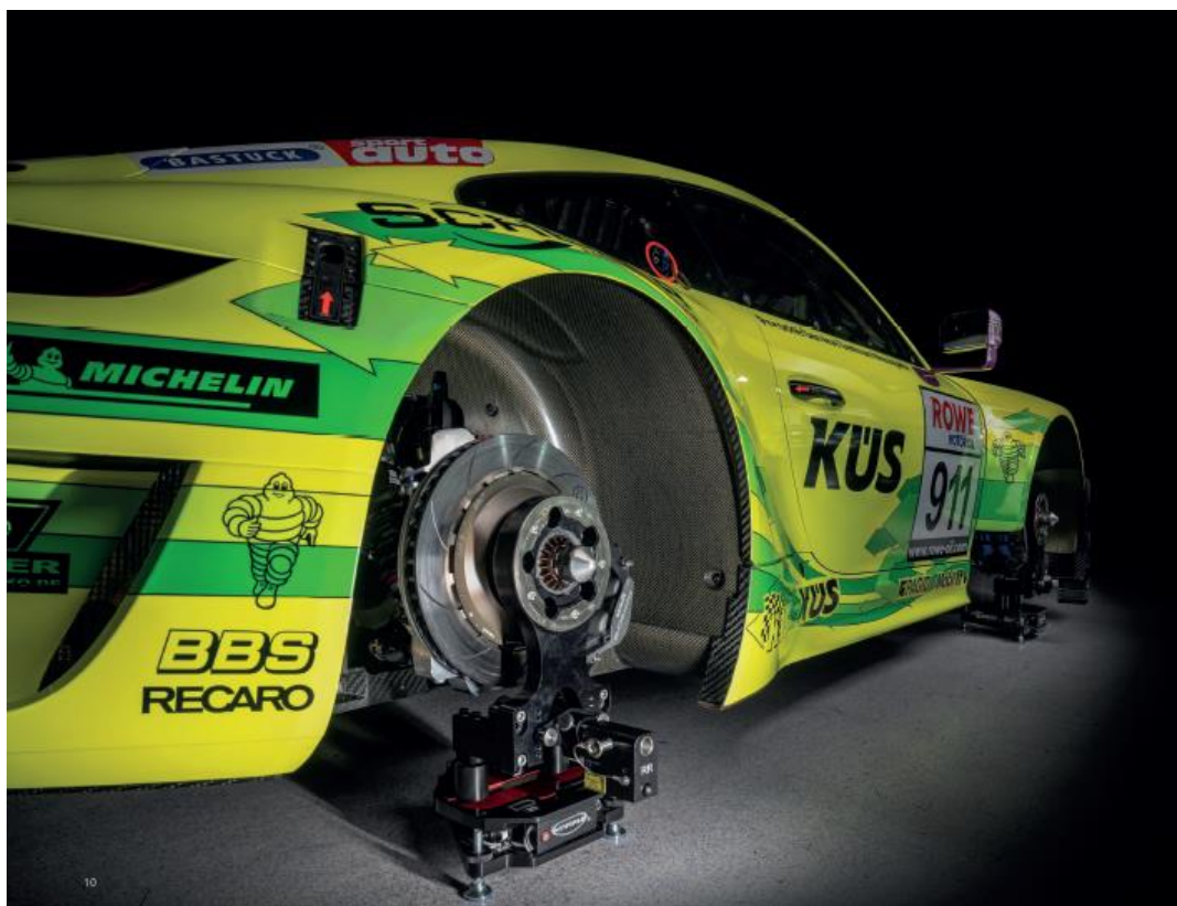
Slika 4.17. Pobjednički automobil na utrci „ADAC 24h of Nürburgring“ 2021. godine s montiranim Manthey Racing sustavom za podešavanje geometrije ovjesa [17]
