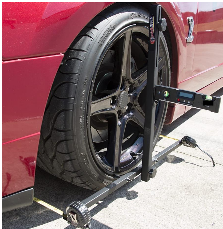
Slika 4.8. Poprečno mjerenje usmjerenosti kotača
