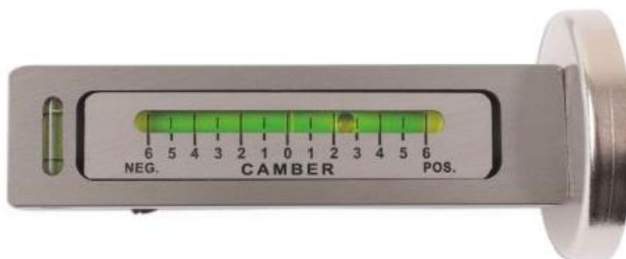
Slika 4.2. Libela za mjerenje bočnog nagiba kotača [8]
