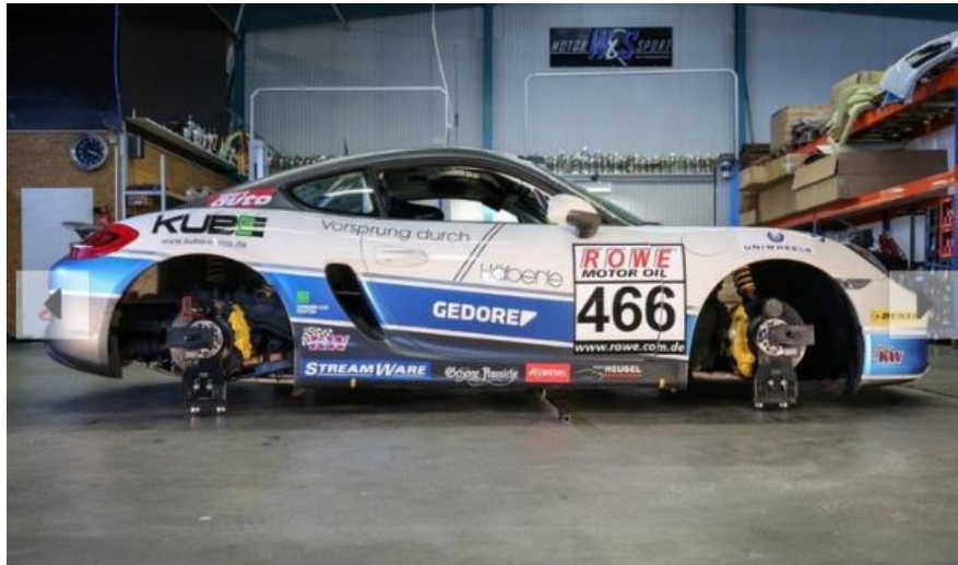
Slika 4.15. W&S Motorsport sustav za podešavanje usmjerenosti kotača [16]
