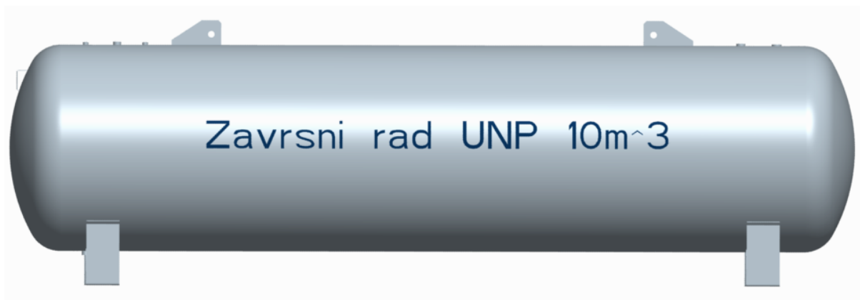
Crtež 1. Sklop nadzemnog spremnik za UNP
