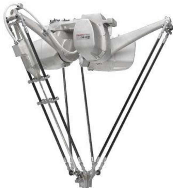
Slika 5. Fanuc DR-3iB/8L delta robot [7]
