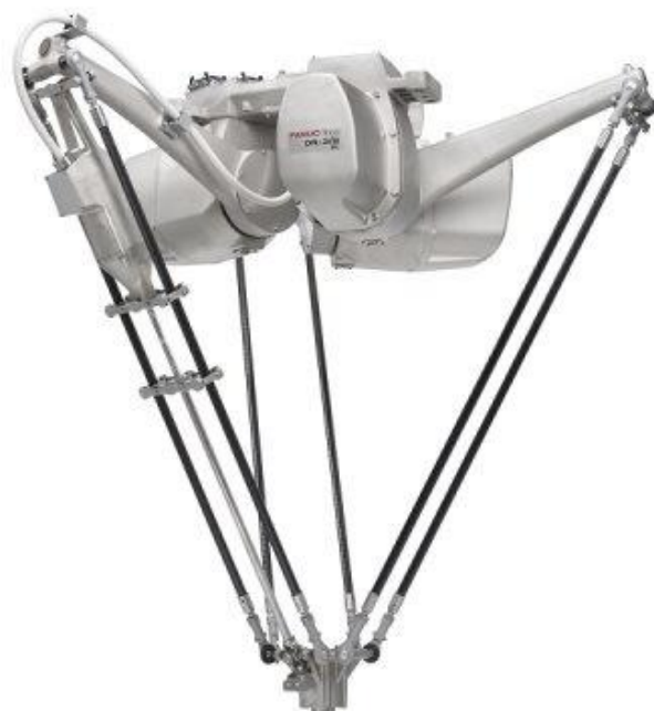
Slika 5. Fanuc DR-3iB/8L delta robot [7]
