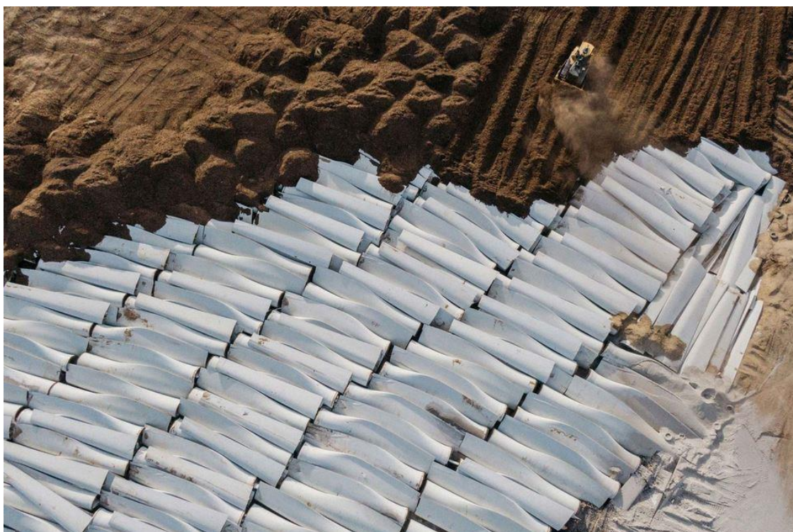
Slika 33. Zakopavanje lopatica vjetroturbina [48]
