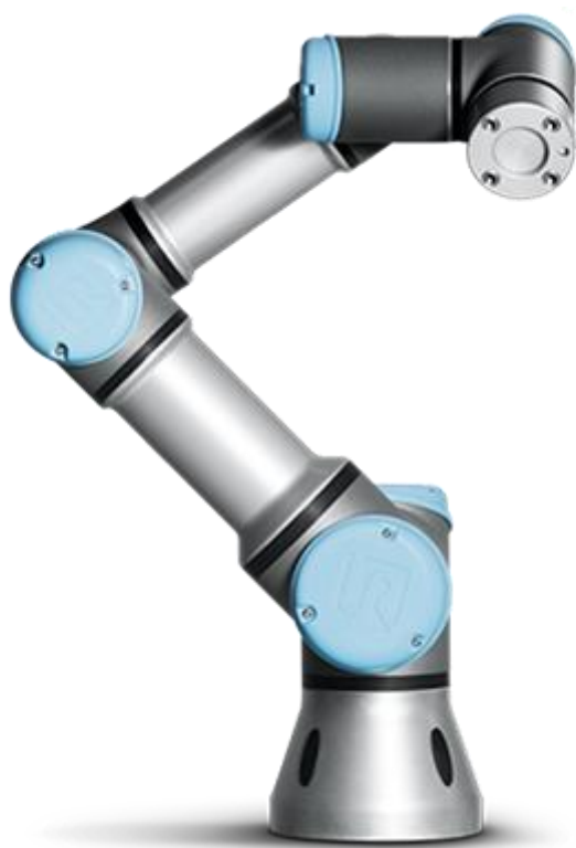
Slika 5. UR3 robotska ruka [14]
