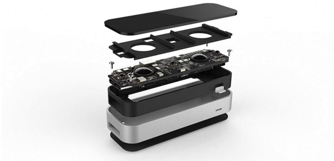
Slika 2. Struktura Leap Motion Kontrolera [6]
