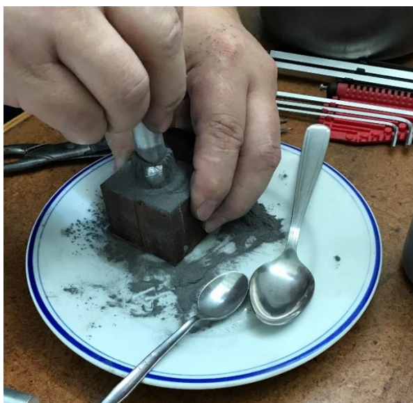
Slika 26. Sabijanje praha u ovitak od aluminijske folije
