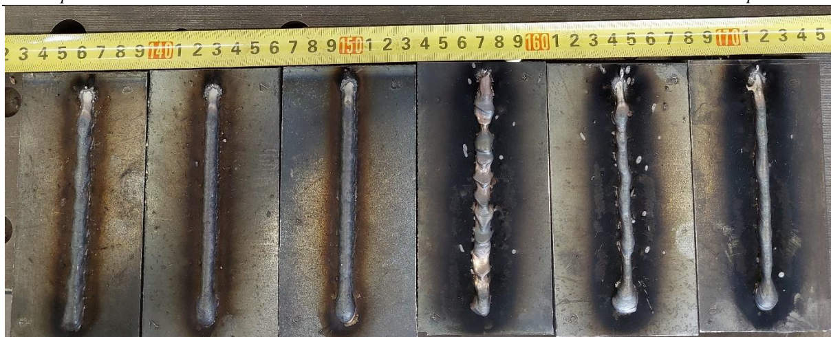
Slika 33. Izgled površine uzoraka nakon zavarivanja
