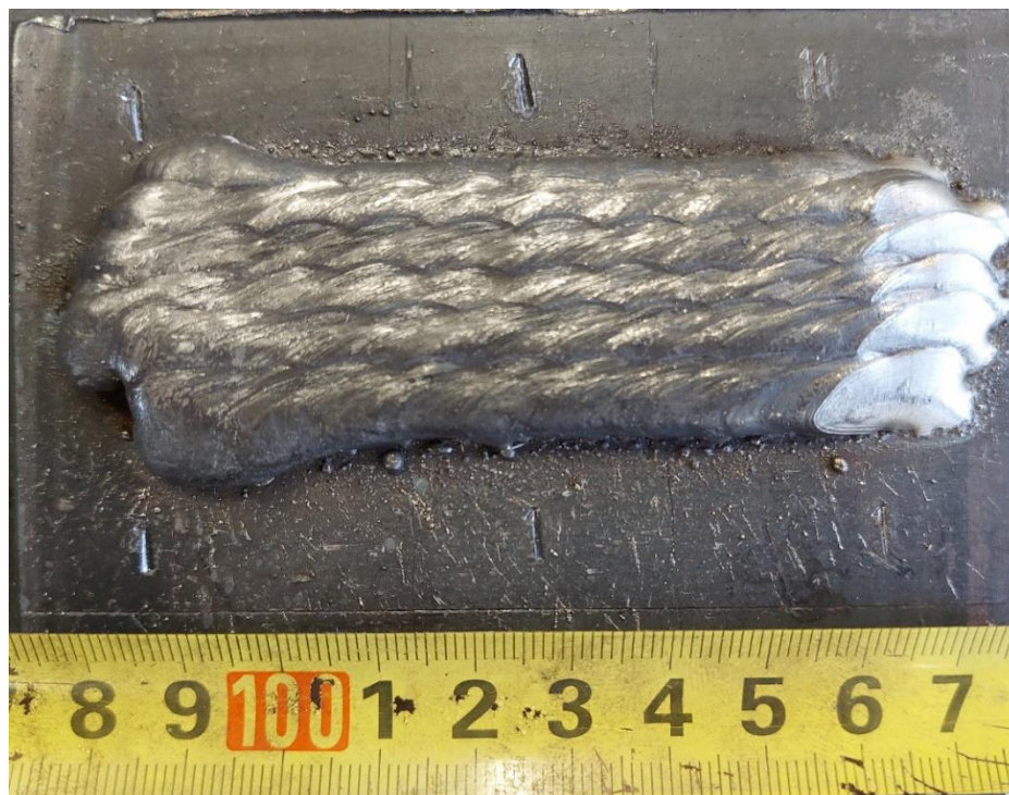
Slika 42. Uzorak 1-1 nakon zavarivanja i četkanja
