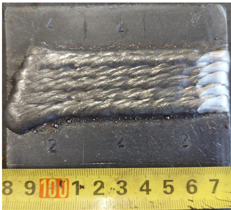
Slika 42. Uzorak 1-1 nakon zavarivanja i četkanja
