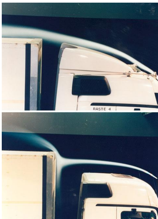
Slika 106. Prikaz zastoja tlaka na kabini [38]
