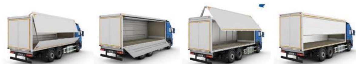
Slika 37. Vrata preko cijele bočne stranice [17]
