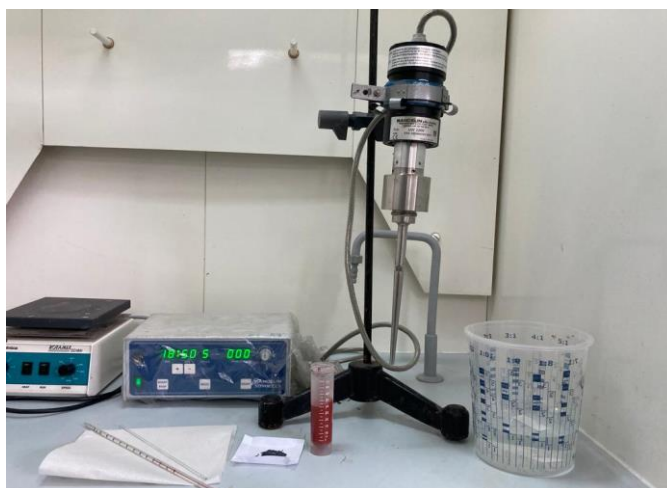
Slika 21. Aparatura za proces miješanja epoksidne smole
