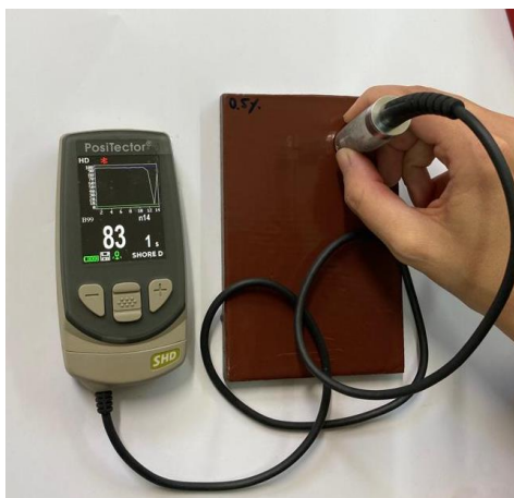
Slika 27. Postupak ispitivanja tvrdoće epoksidnog premaza
