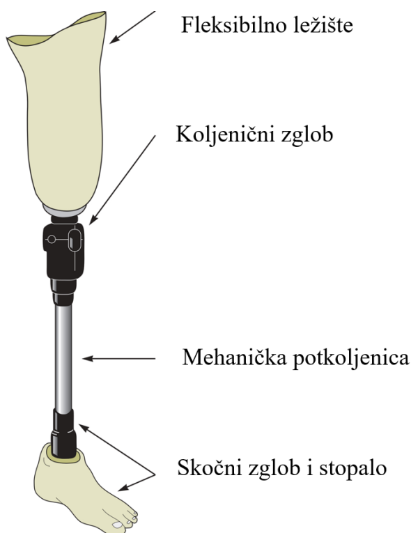
Slika 2. Osnovni dijelovi endoskeletne proteze potkoljenice [3]
