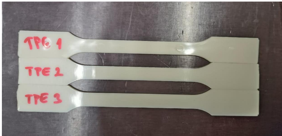
Slika 5.18. Ispitna tijela od elastoplastomernog materijala (TPE)
