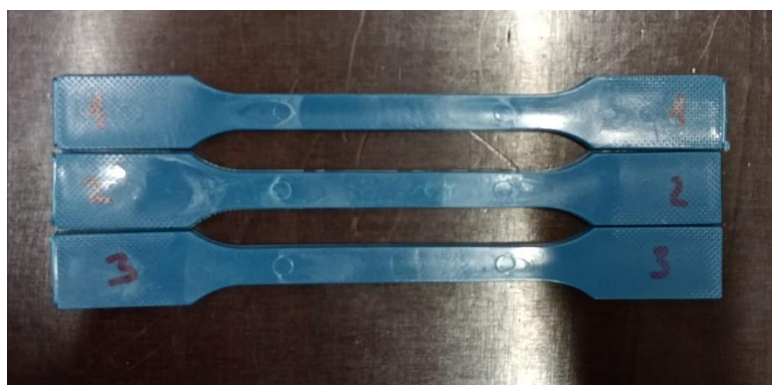
Slika 5.12. Ispitna tijela polietilena (PE)
