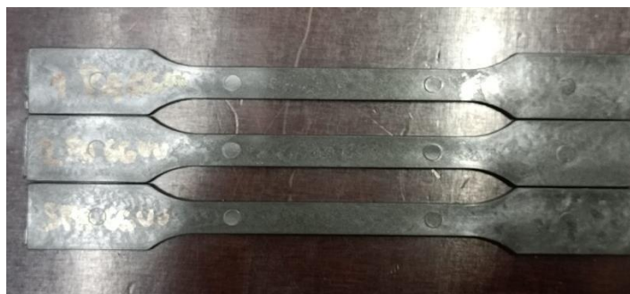
Slika 5.15. Ispitna tijela od poliamida (PA 66) ojačanog s 30 % ugljičnih vlakana
