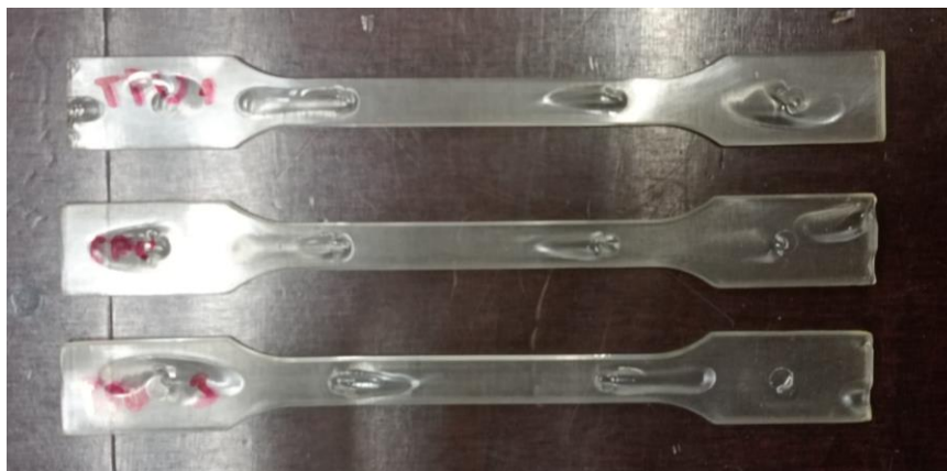
Slika 5.19. Ispitna tijela od poliuretanskog elastomera (TPU)
