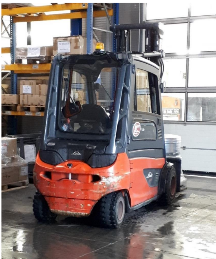
Slika 31. Električni čeoni viličar
