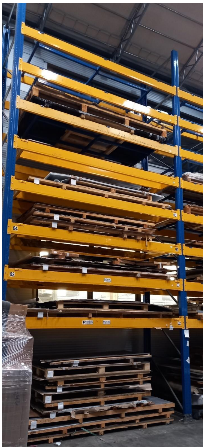
Slika 23. Skladištenje vanstandardnih paleta
