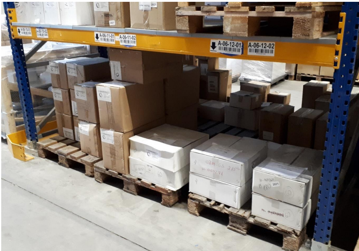
Slika 27. Označavanje skladišnih pozicija
