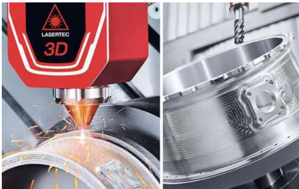
Slika 15. LASERTEC lijevo lasersko navarivanje, desno glodanje
