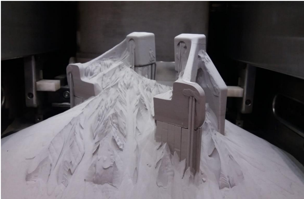
Slika 13. Proizvod u metalnom prahu nakon procesa SLM-a [28]
