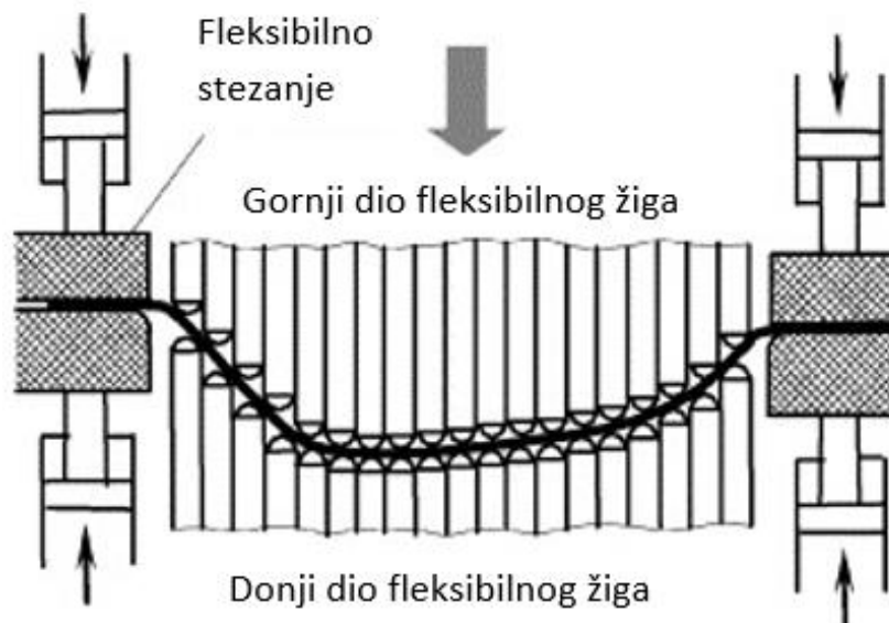
Slika 14. Formiranje u kalupu u više točaka istovremeno sa segmentiranom matricom [30]
