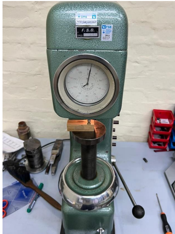
Slika 26. Uredaj za ispitivanje tvrdoće uzoraka Brinellovom metodom
