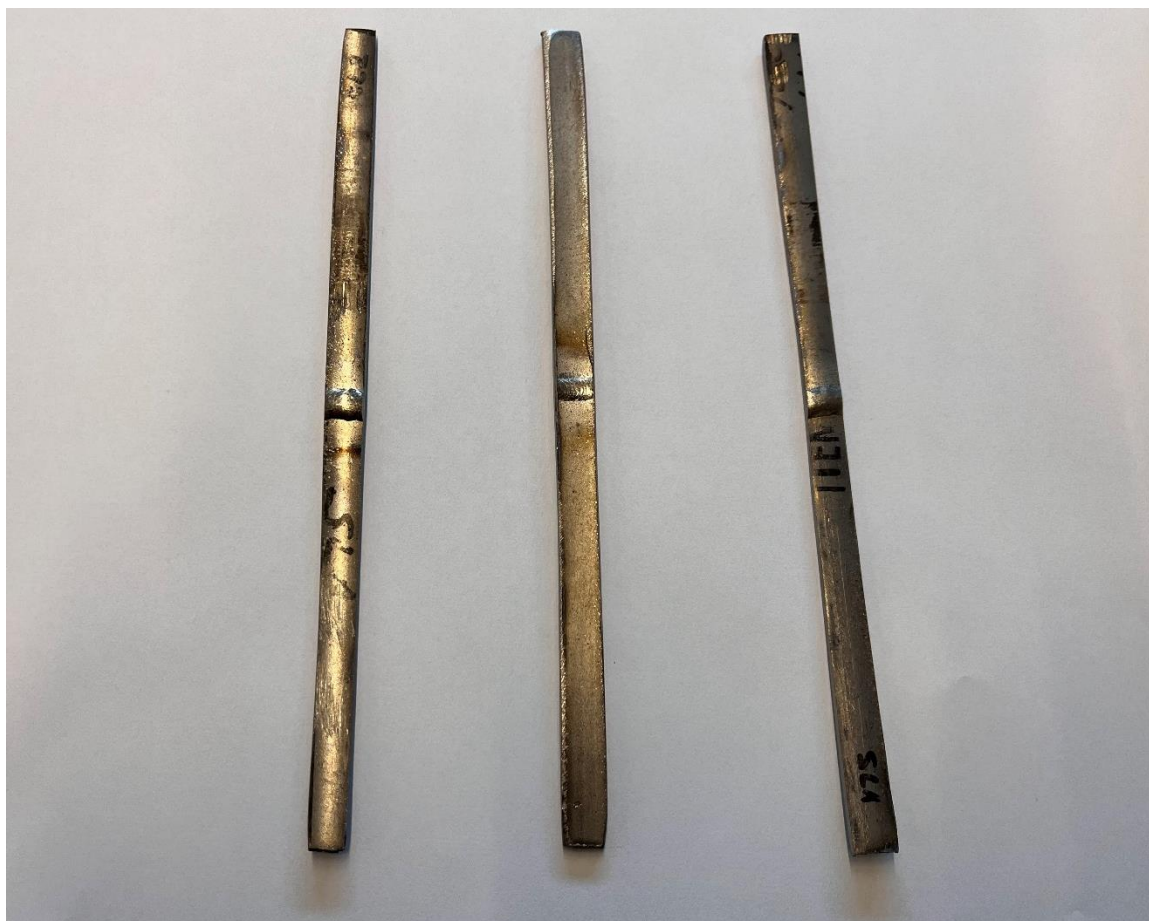
Slika 22. Pripremljeni uzorci za savojno ispitivanje
