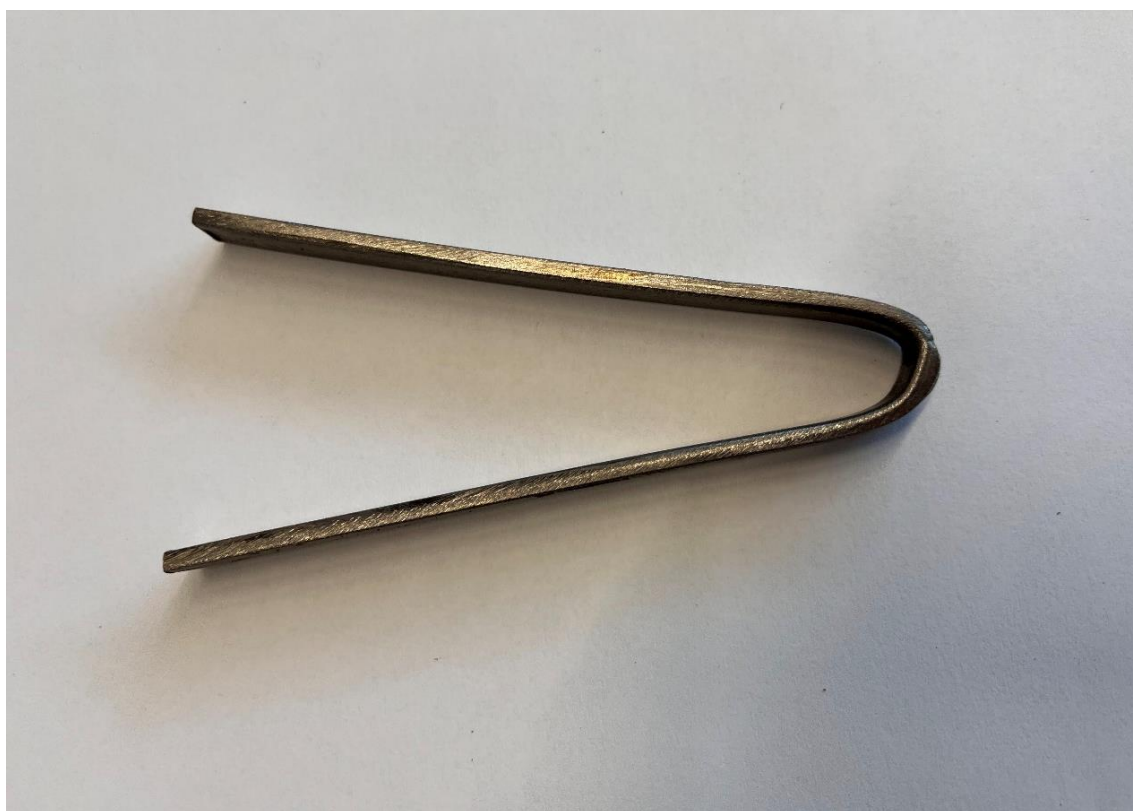
Slika 24. Ispitni uzorak nakon završenog savojnog ispitivanja
