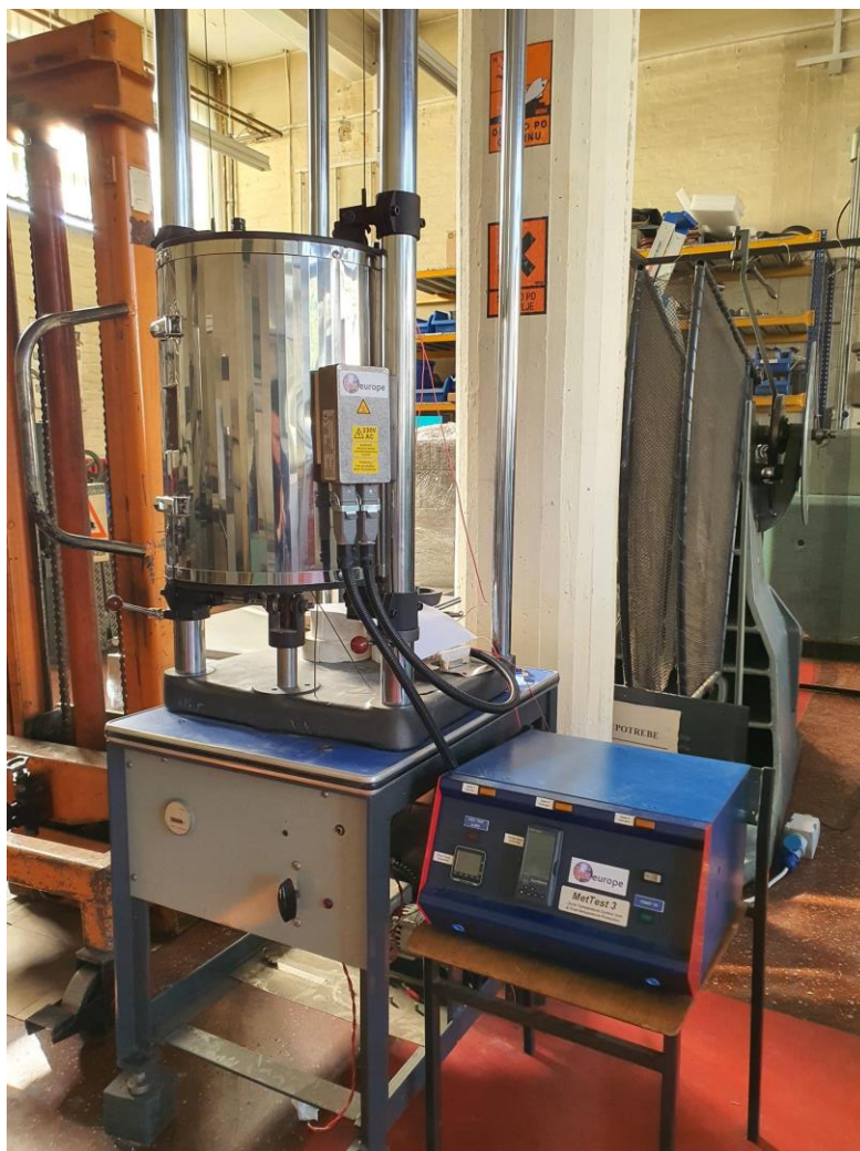
Slika 21. Toplinska komora u LIMS-u
