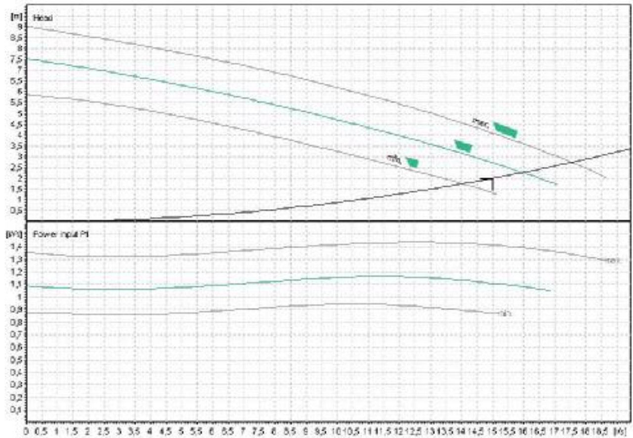
Slika 54: Radna točka pumpe za vodu
