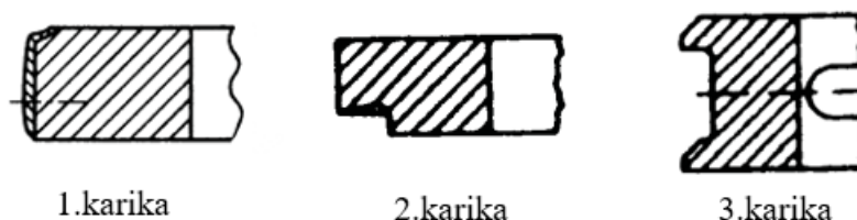
Slika 35. Klipni prsteni na klipu motora Hatz 1D81 [10]
