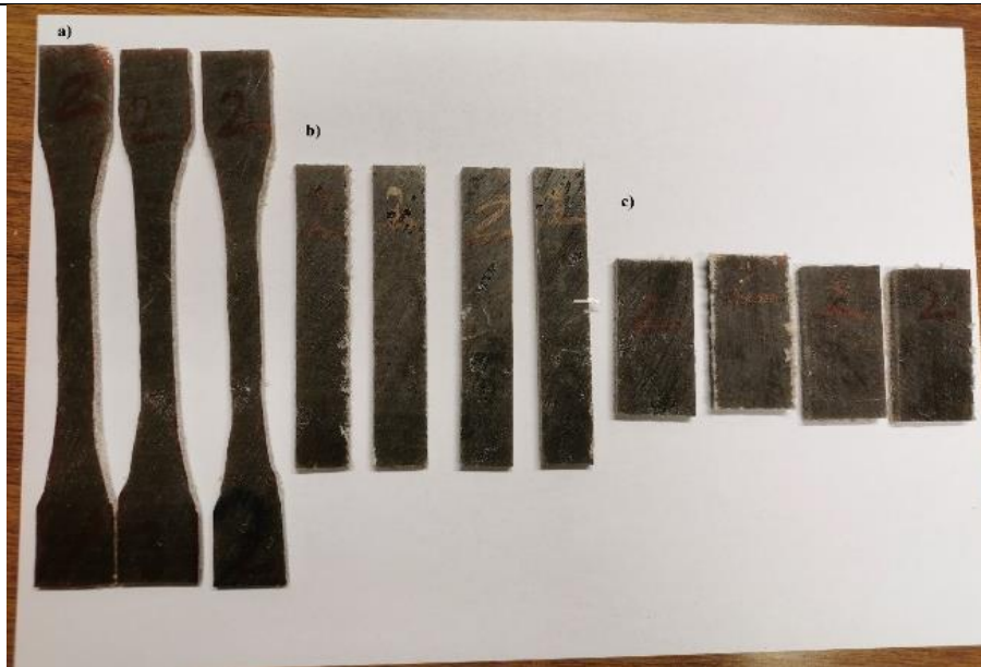
Slika 5.1 Ispitivani uzorci biokompozitnog laminata [24]
