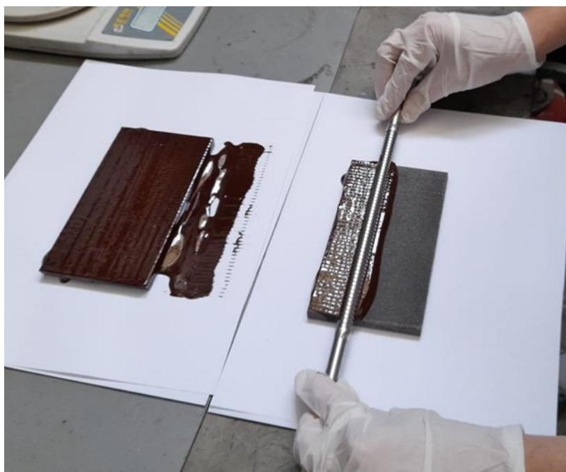
Slika 16. Postupak nanošenja premaza pomoću aplikatora.
