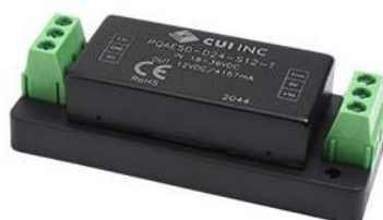
Slika 17. Regulator napona PQAE50-T [14]
