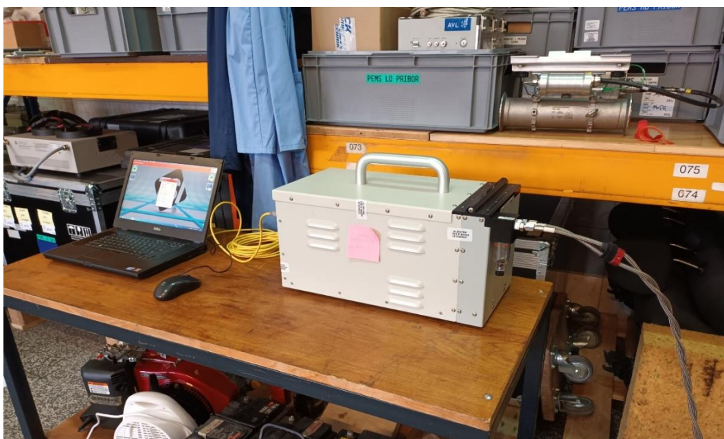
Slika 4.2. Ispitni postav za mjerenje čestica TSI NPET uređajem
