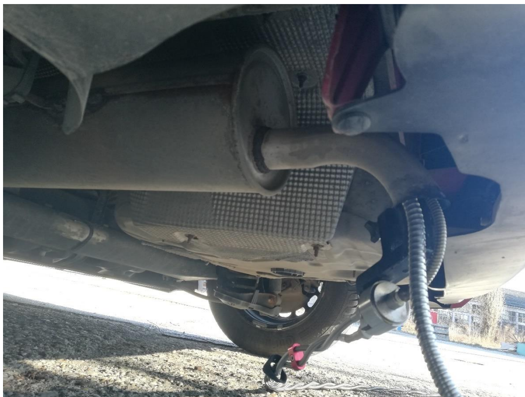
Slika 5.4. Senzor mjernog uređaja u ispušnoj cijevi
