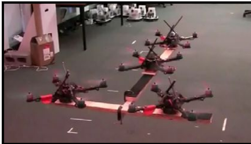
1.11 Četverorotorni helikopteri GRASP laboratorija prenose konstrukcijski element [8]
