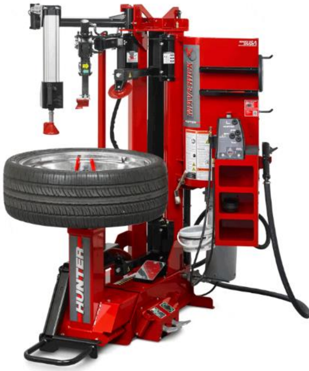
Slika 12. Automatizirani sustav za izmjenu guma tvrtke Hunter Engineering [16]
