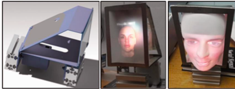
Slika 4 Postolje, ravna projekcija, 3D projekcija PLEA [2]
