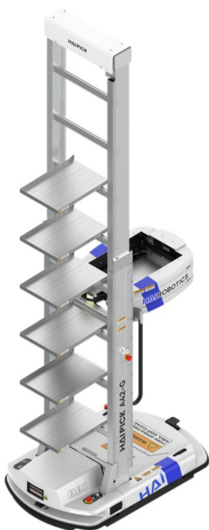
Slika 14. HaiPick A42-M robot [16]
