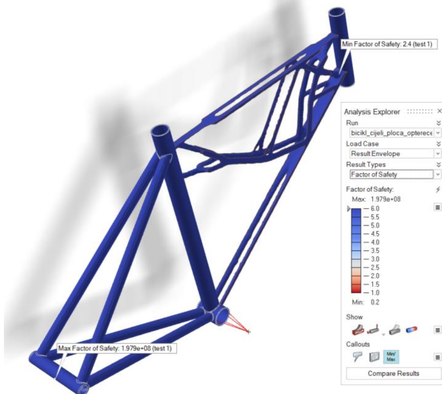
Slika 56. Rezultati testiranja optimiranog okvira, sigurnost
