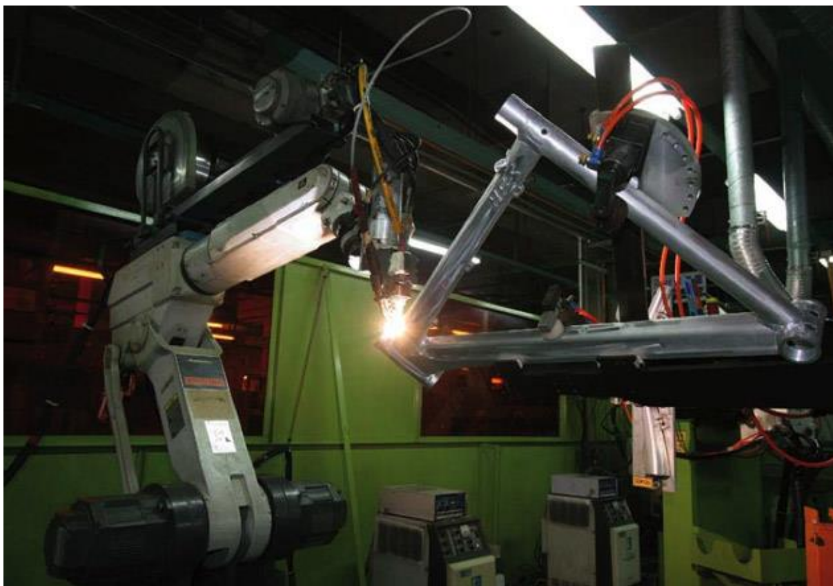
Slika 8. Strojno zavarivanje okvira bicikla [11].
