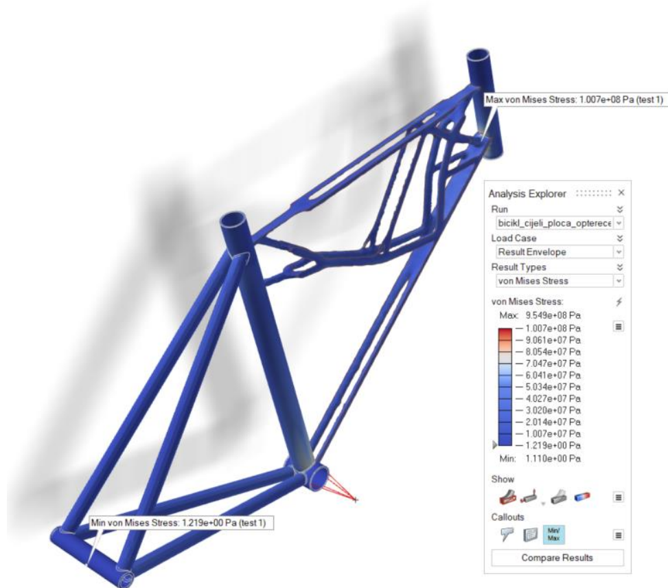
Slika 57. Rezultati testiranja optimiranog okvira, naprezanje
