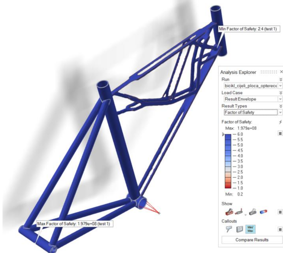
Slika 56. Rezultati testiranja optimiranog okvira, sigurnost
