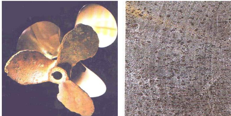
Slika 8. Decinkacija mjedi i grafitizacija sivog lijeva [4]
