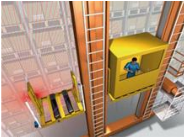
Slika 7. Person-on-board S/R dizalica
