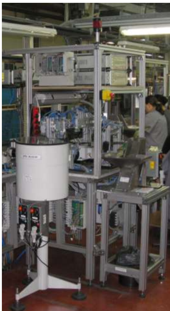
Slika 5. Automat za montažu čahure, opruge i ležaja
