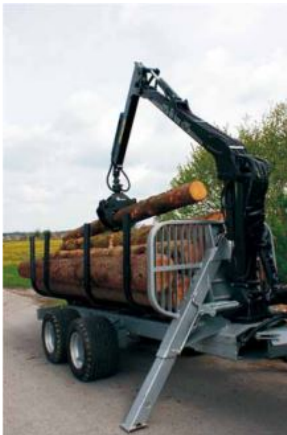
Slika 31. Prikolica RW 9242 K-Line u izvedbi za prijevoz drvenih trupaca [17]
