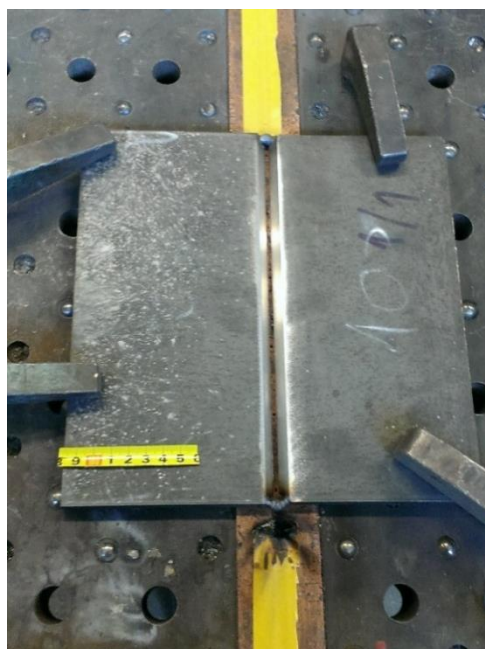
Slika 22 Uzorak 1 fiksiran prije početka zavarivanja
