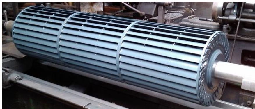
Slika 1 Rotor Ossberger turbine[1]
