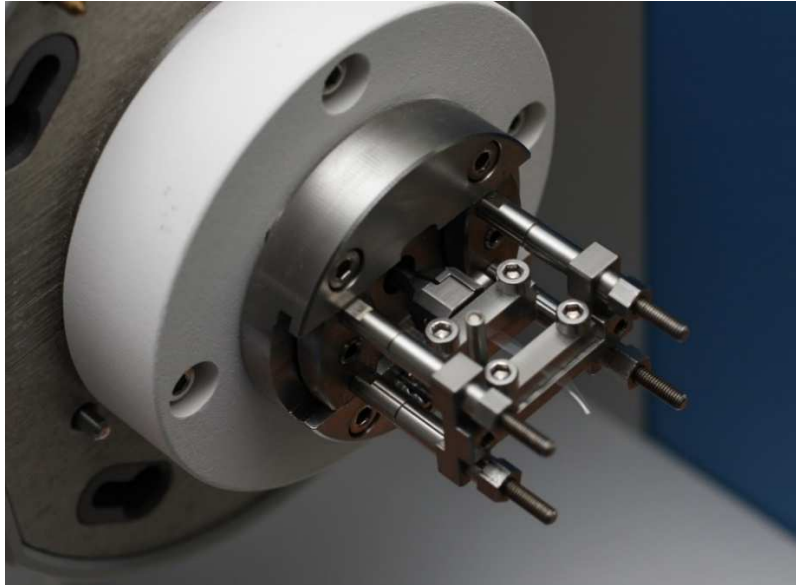
Slika 5.8. Prihvat ispitnih tijela na uređaju TT DMA [14]
