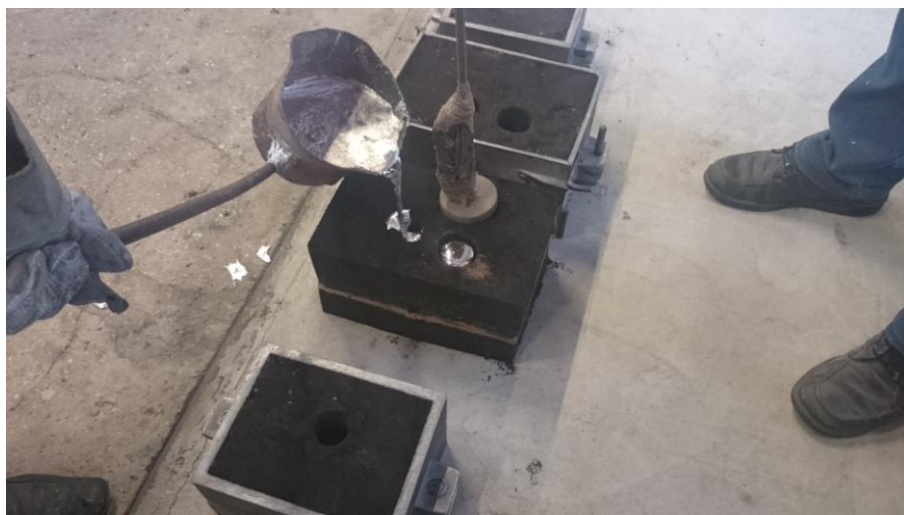
Slika 61. Postupak ulijevanja taline
