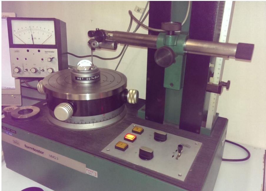
Slika 13. 3D prikaz uređaja za mjerenje kružnosti Mahr MMQ3
