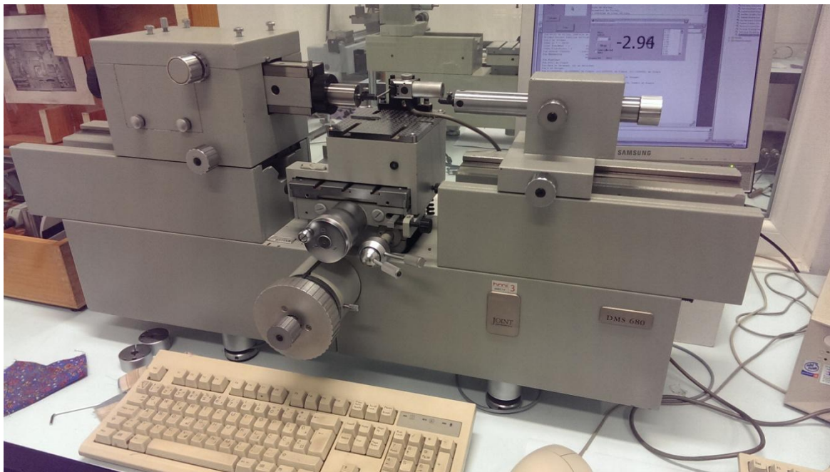
Slika 16. ULM uređaj za umjeravanje ticala
